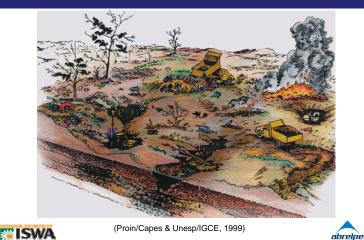
Local onde os resíduos são descartados sobre o solo (sem proteção), porém contam com alguns controles para minimizar os impactos – compactação, cobertura e disposição ordenada.
