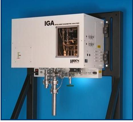
Układ sorpcyjny Equipment for assessment of outburst parameters
