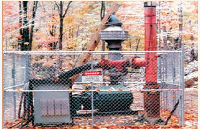
**Figura 2 : Pozzo utilizzato per l'estrazione di CMM da un livello di carbone post estrazione collassato.**
