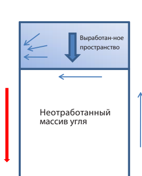
Диаграмма 4.2 Традиционная возвратноточная схема проветривания
